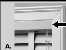
A. Profondeur requise pour le montage affleuré
